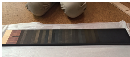
漆を塗り重ねる手順の見本。下地の工程だけで10数段階、塗っては研いでを繰り返す。完成したら途中は見えない。
